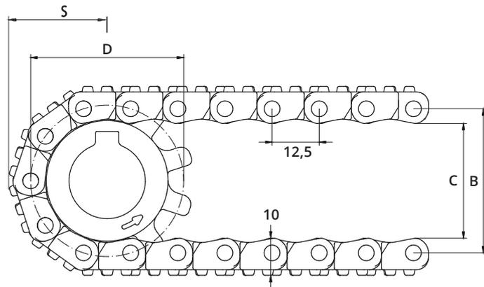
S= Störkante, B = Teilkreisdurchmesser, C = Innendurchmesser, D = Umlenkdurchmesser
