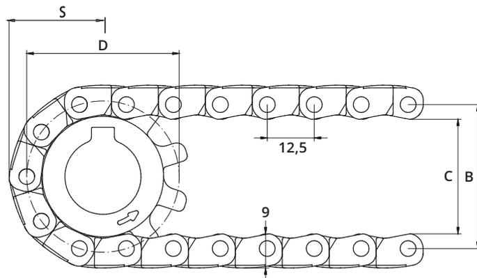
S= Störkante, B = Teilkreisdurchmesser, C = Innendurchmesser, D = Umlenkdurchmesser
