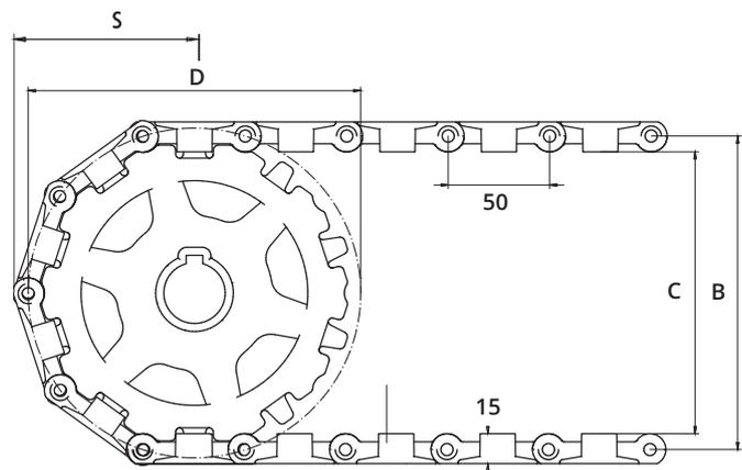
S= Störkante, B = Teilkreisdurchmesser, C = Innendurchmesser, D = Umlenkdurchmesser
