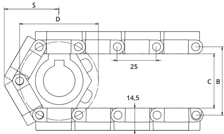
S= Störkante, B= Teilkreisdurchmesser, C= Innendurchmesser, D= Umlenkendurchmesser
