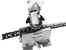
Abschleifen der Bolzenenden
