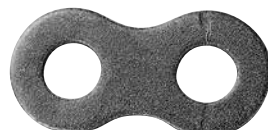
Beispiel eines Risses
