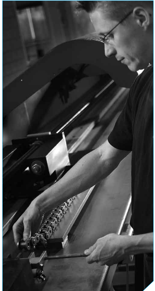
Paarweises vorrecken für Parallellauf
