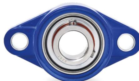
Der Edelstahlinsatz ist lebensdauergeschmiert, mit lebensmittelkonformer Fettfüllung nach NSF H-1 Freigabe. Ein Schmiernippel am Gehäuse wird somit nicht benötigt. Falsche Nachschmierungen werden ausgeschlossen.
